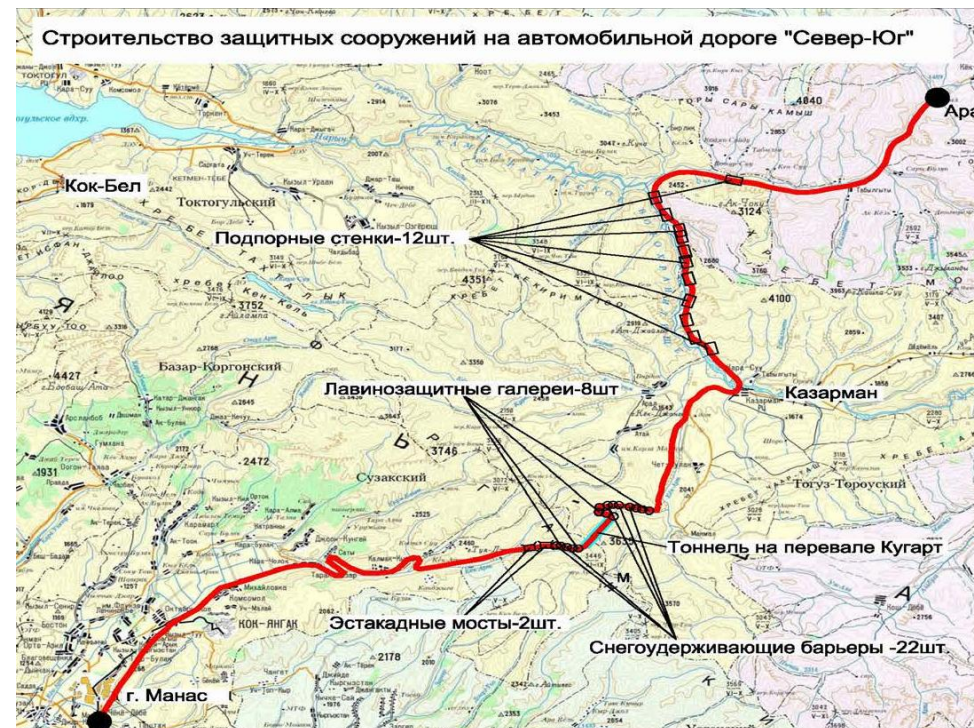
Строительство защитных сооружений на альтернативной автомобильной дороге Север – Юг
