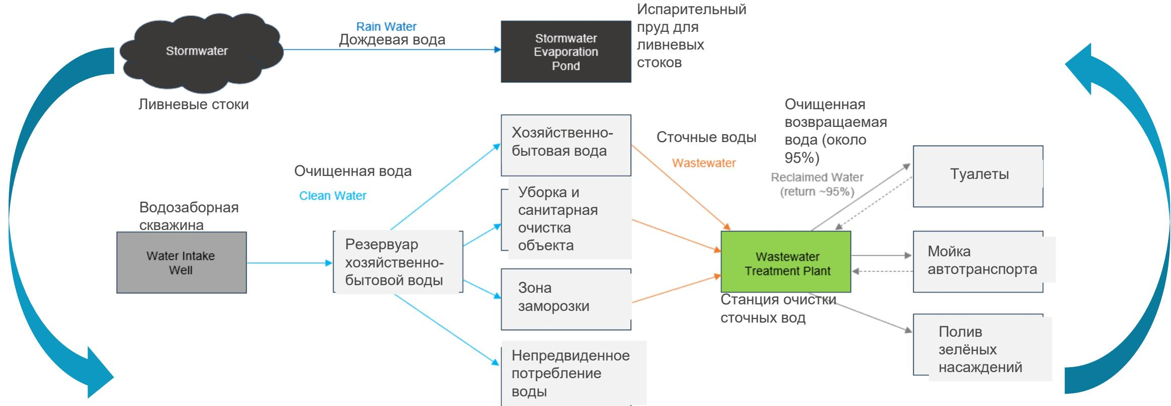
Система обеспечивает локальную очистку сточных вод с их повторным использованием для технических нужд, снижая потребление пресной воды и операционные затраты.
