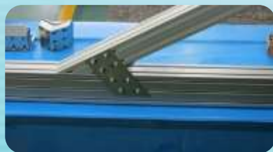
Алюминиевый профиль + болты с Т-образной головкой
